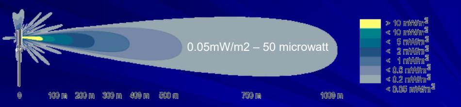
Schematischer Verlauf der Leistungsflußdichte der oben aufgeführten Antenne in Abhängigkeit von der Entfernung Der Bereich oberhalb des Vorsorgewertes des Ecolog-Institutes von 10 mW/m<sup>2</sup> ist gelb hervorgehoben
